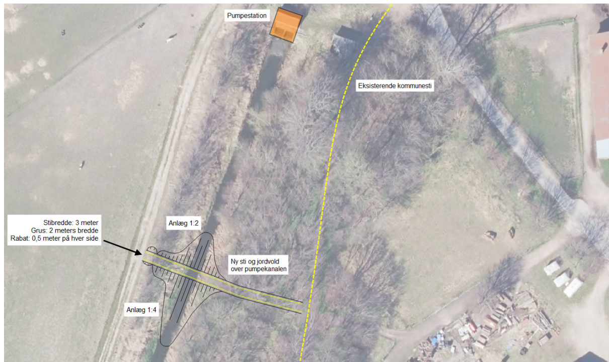
Figur 40 Dæmning over Pumpekanalen.
